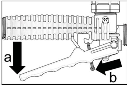
Il tubo spruzzatore è ruotabile nella valvola manuale – dopo avere allentato il dado a risvolto (Fig. 2, e). Questo è particolarmente utile per l'irrorazione sotto il fogliame.
