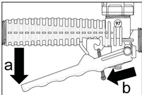
Après avoir desserré l'écrou raccord (Fig. 2, e), la lance peut tourner dans la valve à gâchette. Cette fonction est utile pour les applications en dessous des feuilles.
