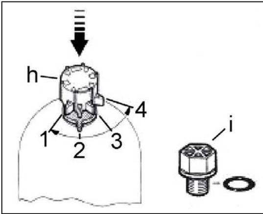
Para ajustar la cantidad de pulverización o bien el tamaño de las gotitas, regule la presión de pulverización mediante los escalones en un campo de aprox. 1 a 4 bares.
