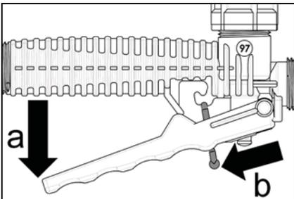
El tubo de rociado se podrá girar en el grifo de cierre – después de haberse soltado la tuerca de racor (Fig. 2, e). Esto será muy útil cuando se tenga que realizar la pulverización subfoliar.
