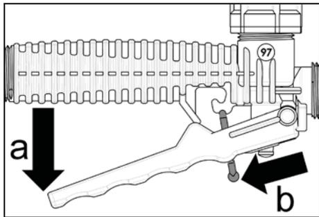
Das Spritzrohr ist im Handventil – nach Lösen der Überwurfmutter (Fig. 2, e) – drehbar. Dies ist nützlich für die Unterblattspritzung.
