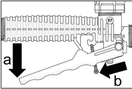
De sproeilans kan in het handventiel – na het losdraaien van de dopmoer (Fig. 2, e) – worden gedraaid. Dit is nuttig bij het bespuiten van de onderkant van bladeren.
